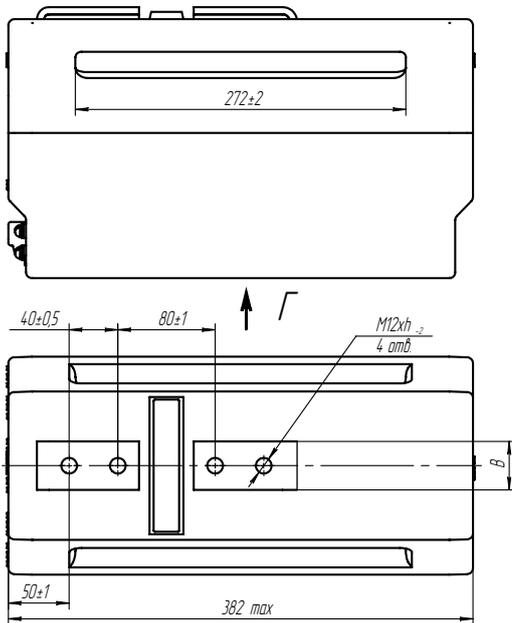
Рис. 6. Общий вид трансформатора ТОЛ-10-М-4 на токи от 5 до 500А. Остальное см. рис. 3
