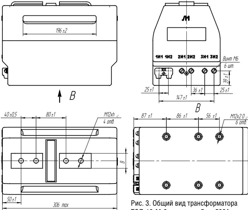
Рис. 3. Общий вид трансформатора ТОЛ-10-М-3 на токи от 5 до 500А. Остальное см. рис. 1
