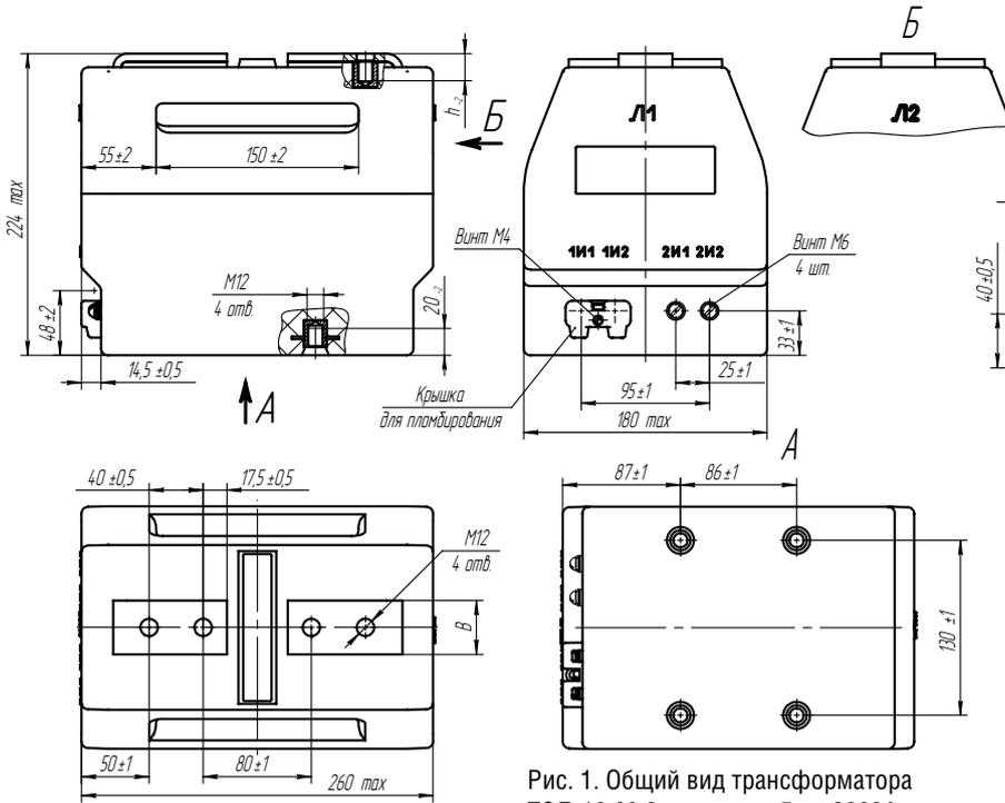
Рис. 1. Общий вид трансформатора ТОЛ-10-М-2 на токи от 5 до 2000А
